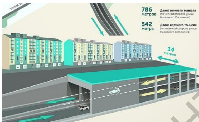
Рисунок 3 – Схематический вид винчестерского тоннеля в Москве
