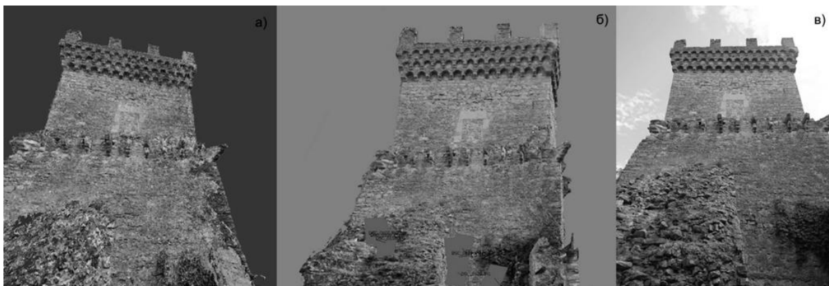
Рис. 3. Плотное облако точек в Rescap 360 (а); текстурированная модель в AgisoftPhotoscan (б); исходная фотография (в)
