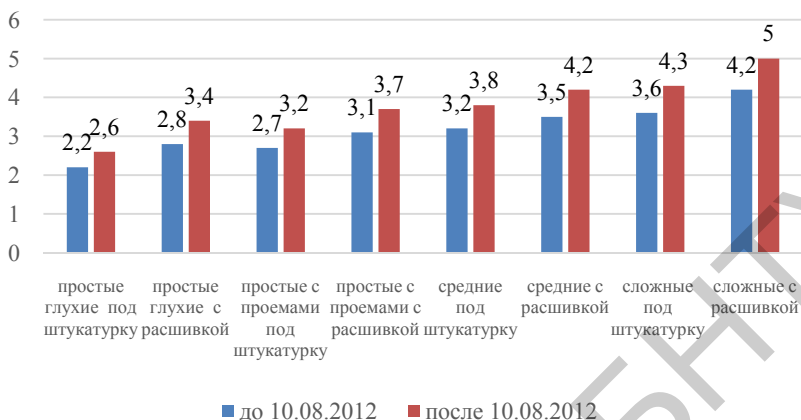
Рисунок 1 – Изменение норм затрат труда на выполнение работ по кирпичной кладке стен толщиной 2 кирпича до и после утверждения результатов нормирования постановлением № 24 от 10.08.2012г., чел.-час.
