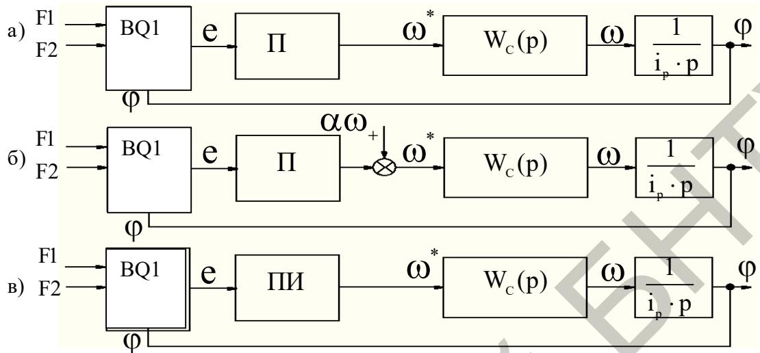
Рисунок 2 – Структурная схема системы с П регулятором положения (а), с П регулятором положения с каналом компенсации (б), с ПИ регулятором положения (в).
