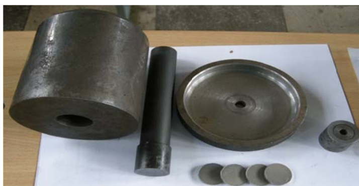
Рисунок 2 – Технологическая оснастка для экструдирования лигатуры из брикетов
