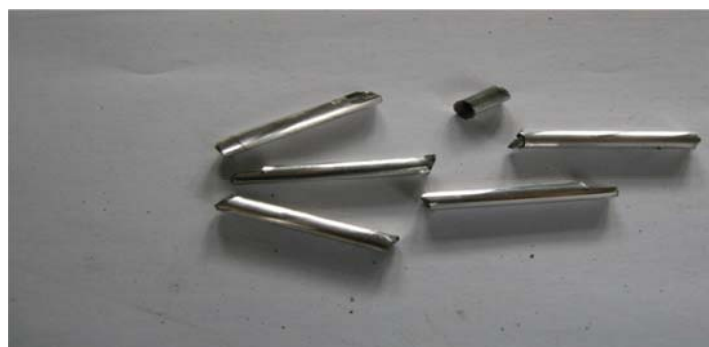
Рисунок 4 – Образцы лигатуры, полученные экструзией
