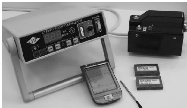
Рисунок 1 – Комплект оборудования для оценки напряженного состояния металла
