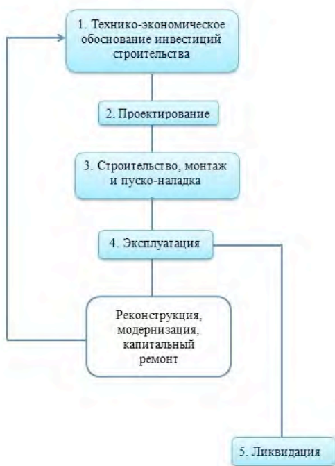
Рисунок 1 – Этапы жизненного цикла очистных сооружений
