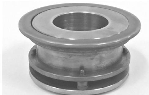
Рисунок 1 – Внешний вид электрода-катода для возбуждения разряда с эффектом полого катода
