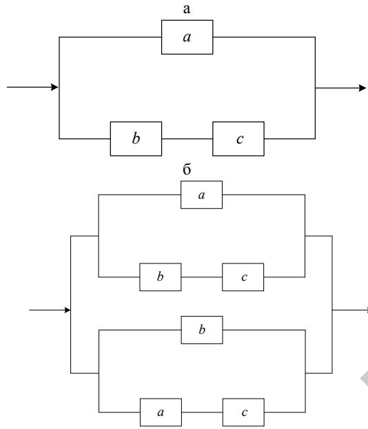
Рис. 4. Структурная схема расчета надежности схемы местного АВР:
