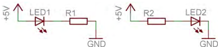
Рисунок 2.31 – Схемы расположения резистора для ограничения тока
