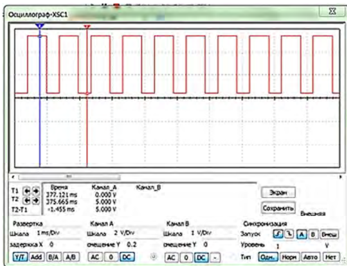
Рисунок 2.37 – Результат моделирования генератора на ИС NE555 в программе Multisim
