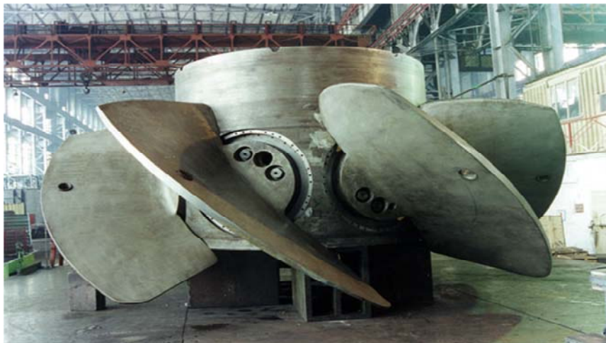
Рис. 4.3. Рабочее колесо реактивной осевой пропеллерной гидротурбины
