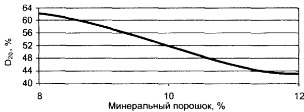
Рис. 5. Зависимость влияния минерального порошка на D_{20} при оптимальном содержании битума и щебня в зоне минимальной долговечности
