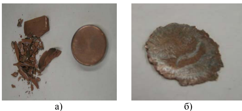
Рисунок 1 – Исходный брикет лигатуры (а), «чипс»-лигатура (б)
