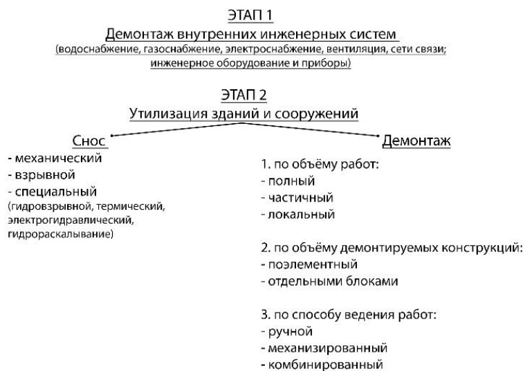
Рисунок. 1 Схема поэтапной ликвидации объектов строительства
