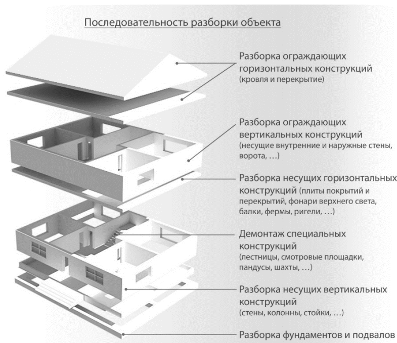
Рис. 2. Схема последовательности демонтажных работ
