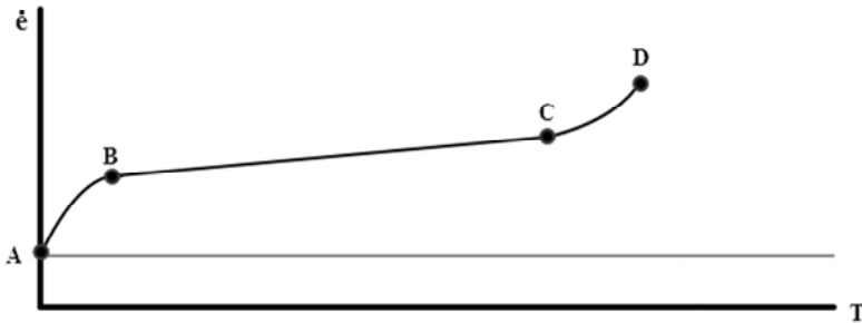
Зависимость деформации детали \epsilon при постоянных напряжениях и температуре от времени T
