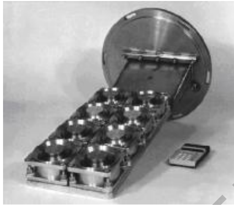
Рисунок 3 – Многокомпонентный электродуговой источник металлической плазмы
