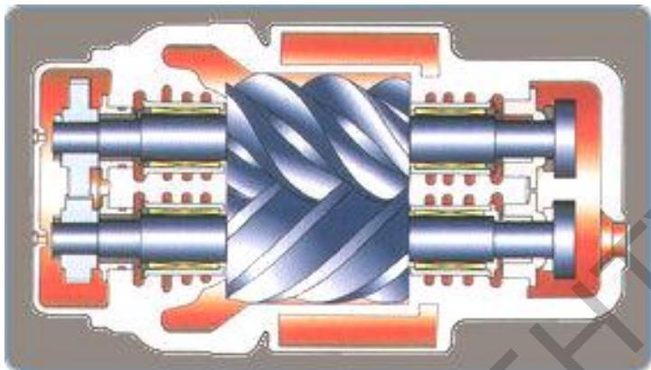
Рисунок 1 – Винтовой компрессор
