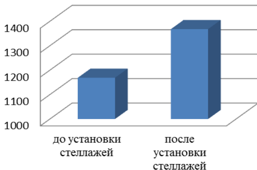
Рисунок 2.18 – Изменение количества паллетомест после установки стеллажей
