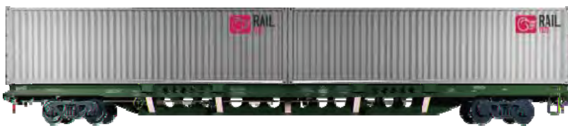
Рисунок 4.20 – Размещение контейнеров на фитинговой платформе
