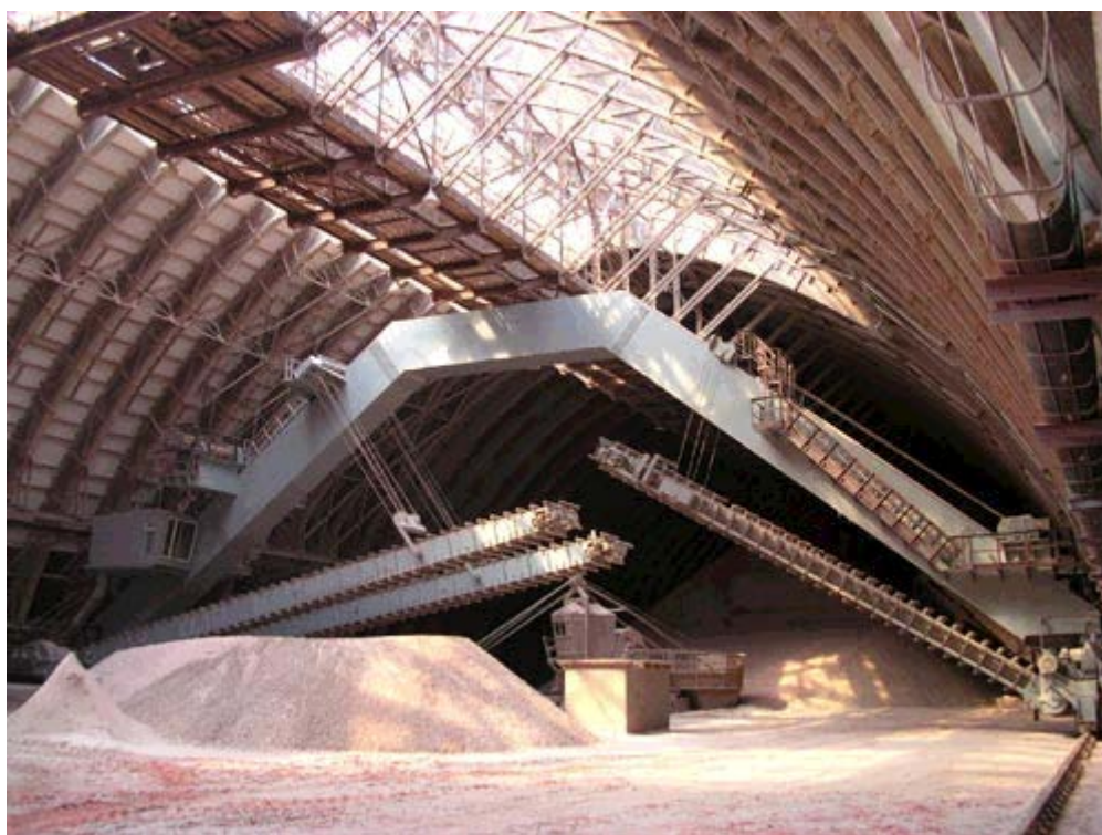
Рис. 1. Кратцер-кран производства “ЗАО Солигорский институт ресурсосбережений с опытным производством”:
