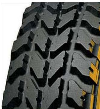
Рис. 11.6. Шины повышенной проходимости
