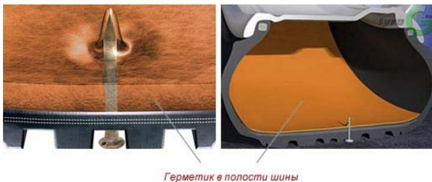
Рис. 11.12. Шина RunFlat с внутренним герметизирующим слоем
