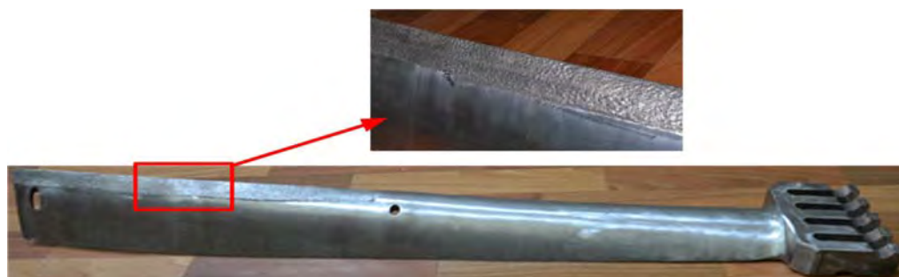
Рисунок 41 – Внешний вид лопатки паровой турбины с КМП на рабочей кромке
