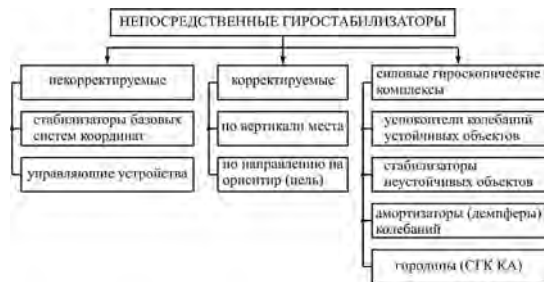
Рисунок 1 – Классификация непосредственных гиросtabilизаторов
