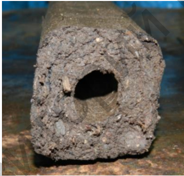
Рисунок 9 – Размеры сформованных и высушенных брикетов многокомпонентного твердого топлива различной формы и внешний вид брикета квадратной формы
