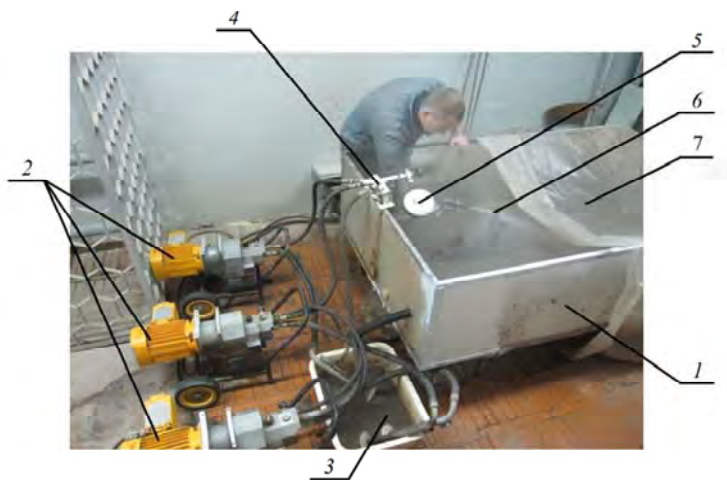
Рис. 2.3. Фотография экспериментального стенда, разработанного для осуществления процесса очистки металлических поверхностей: 1 – рабочий резервуар; 2 – насосы высокого давления; 3 – мерный бак; 4 – тройник; 5 – манометр; 6 – струя рабочей жидкости; 7 – защитная пленка
