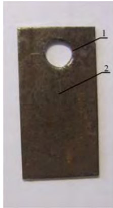
Рис. 1.9. Фотография поверхности стального образца, подвергнутого атмосферной коррозии при хранении в производственных условиях ( T = 20\text{ }^{\circ}\text{C} , влажность K = 60\% ) на ОАО «Агат – электромеханический завод»:
