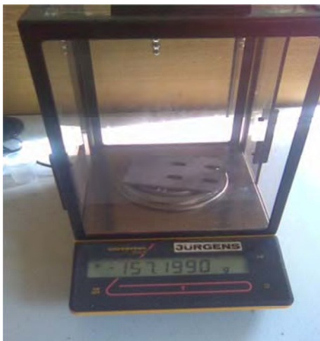
Рис. 2.11. Электронные весы марки «Jurgens» (ФРГ), используемые для оценки массового уноса обработанных образцов
