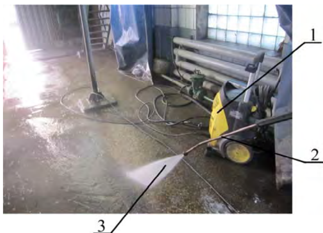
Рис. 2.4. Очистная машина высокого давления «KRAENZLE quadro 1000 TST» (ФРГ) на участке ГАО в ОАО «Пинский ССРЗ» (г.Пинск):
