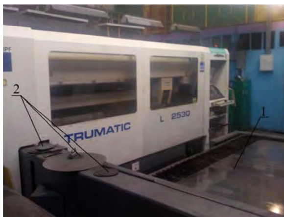
Рис. 5.4. Фрагмент работы лазерного комплекса TRUMATIC по резке стального листа, обработанного по новой технологии струйной ГАО [10]:
