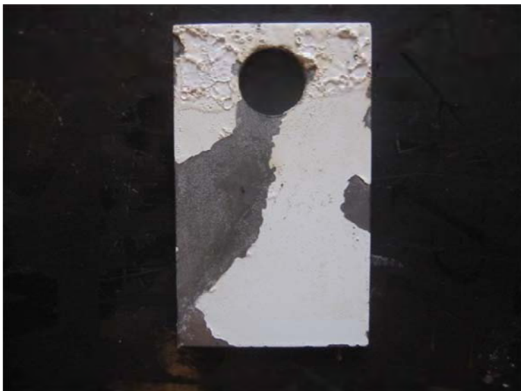
Рис. В3. Фотография поверхности образца после 35 минут кипячения в 20% -м растворе NaCl с последующей 15 минутной выдержкой их в 20%-м растворе NaCl при комнатной температуре: материал – сталь 08кп, p_{ax} = 25 МПа, L = 25 мм, K_{\sigma} = 3\% , K_n = 10^{-5}\% , остальное – вода
