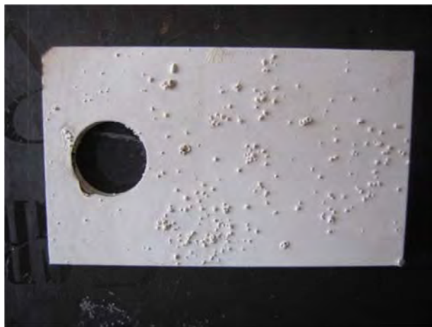
Рис. Г3. Фотография образца, обработанного рабочей жидкостью с содержанием речного песка K_{р.п.} = 4\% после испытаний на коррозионную стойкость: время кипения t_{кип} образца в растворе NaCl (10 %) – 15 минут. Время выдержки в растворе NaCl после кипения – 15 минут
