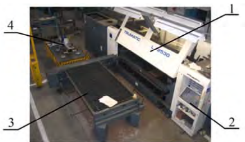
Рис. 5.1. Внешний вид комплекса лазерной резки TRUMATIC: 1 – задвижная крышка; 2 – панель управления; 3 – паллета; 4 – устройство подачи листов
