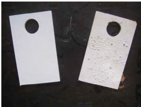
Рис. 4.27. Фотография образцов, обработанных после ГАО растворителем Р-4 и подвергнутых последующему испытанию на коррозионную стойкость: Время испытания на коррозионную стойкость образцов а и б в кипящем растворе NaCl (10 %) – 15 минут. Время выдержки в растворе NaCl после кипения – 15 минут; а – образец обработан рабочей жидкостью на основе бентонита ( K_6 = 3\% ); б – образец обработан рабочей жидкостью на основе речного песка ( K_{р.п.} = 4\% ). Материал – сталь 08кп
