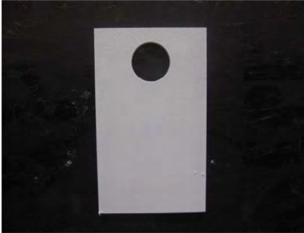
Рис. В1. Фотография образца после проведения операций ГАО и окраски материал – сталь 08кп, p_{ex} = 25 МПа, L = 25 мм, K_6 = 3\% , K_n = 10^{-3}\% , остальное – вода
