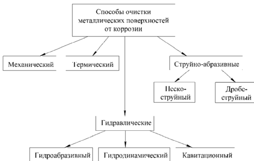
Рис. 1.11. Схема применяемых способов для очистки металлических поверхностей от коррозии [1–27, 82–90]
