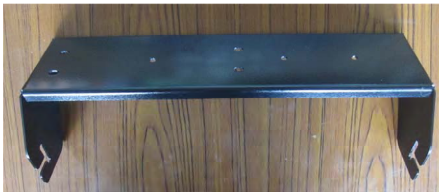
Рис. 5.5. Кронштейн ЦИКС.745422.057, изготовленный с применением ГАО в условиях ОАО «Агат–электромеханический завод»
