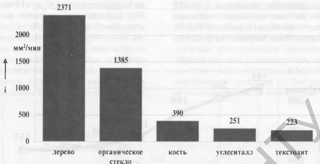
Рис. 5. Значения интенсивности распиливания образцов из различных материалов испытываемым отрезным диском
