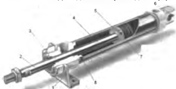
Рис. 3. Конструктивное исполнение пневмоцилиндра S85N20-40S: 1 – кронштейн крепления пневмоцилиндра; 2 – шток; 3 – маслоотражатель-
