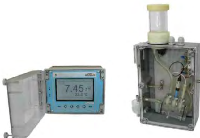
Рисунок 5.5 Внешний вид рН-метра АТЛАНТ 2101
