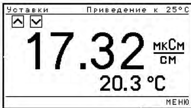
Рисунок 5.2. Пример возможного состояния дисплея кондуктометра
