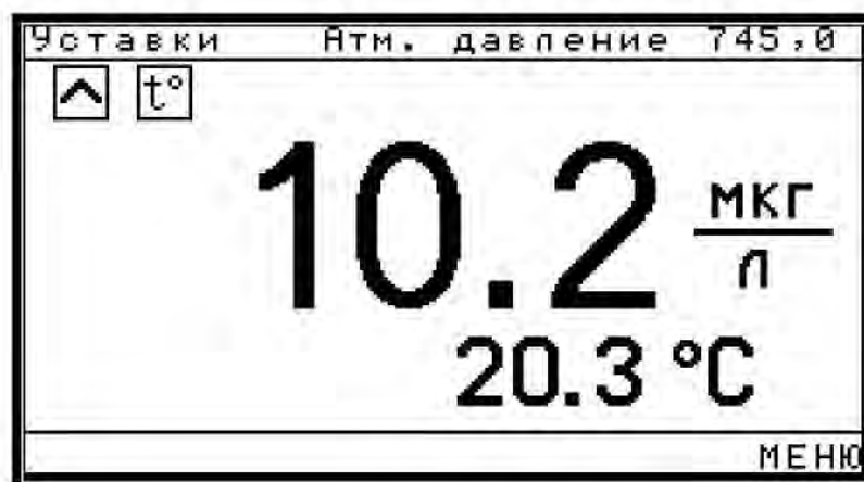
Рисунок 5.11. Пример возможного состояния дисплея кислородомера.
