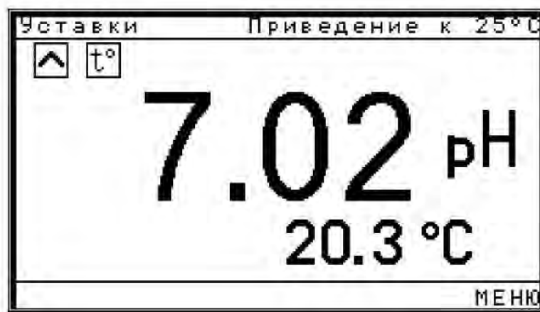
Рисунок 5.6 Внешний вид дисплея рН-метра
