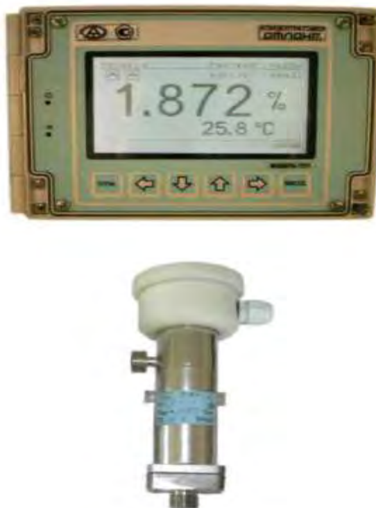
Рисунок 5.4 Внешний вид концентратомера АТЛАНТ 1211
