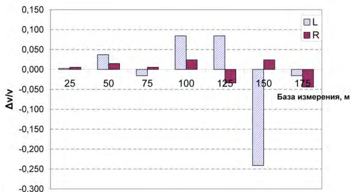
Рис. 7.8 – Зависимость вариации дифференциальной скорости УЗ импульса продольной волны и волны Релея от базы измерения для серии ТВ: L – для импульса продольной волны, R – для импульса волны Релея
