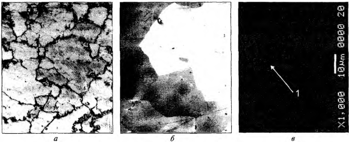
Рис. 1. Микроструктура стали 110Г13Л (плавка 2) в литом (а) и закаленном (б, в) состоянии: металлографические исследования (а, б), исследования методом сканирующей электронной микроскопии (в), а — x100; б — x200; в — x1000
