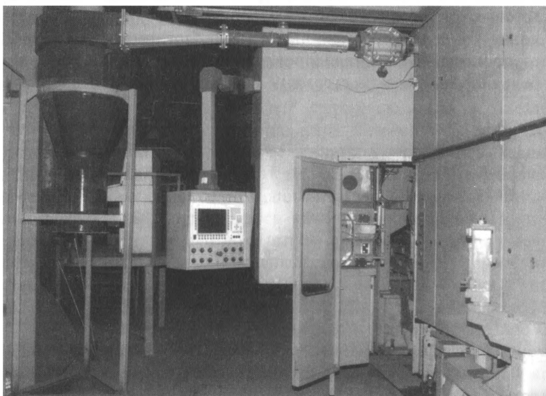
Система управления формовочным блоком и устройство быстрой смены оснастки
