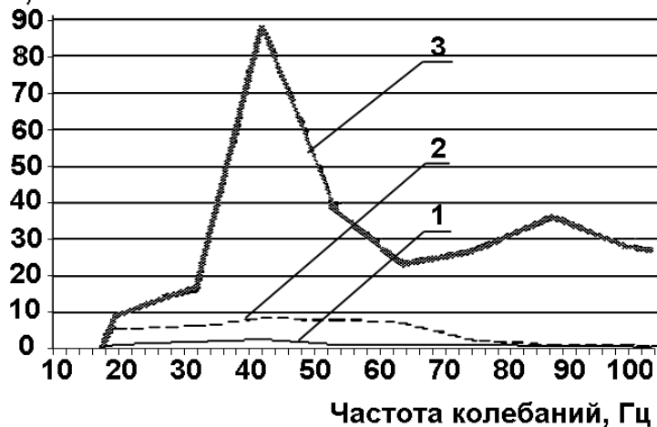
Рис. 2. Амплитудно-частотные характеристики распиловочной секции с центробежным вибратором для различных значений массы дебаланса: 1 – 3,43 г; 2 – 5,28 г; 3 – 6,28 г
