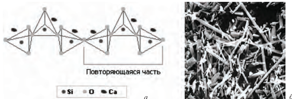
Рис. 5. Структура волластонита, характеризующаяся повторяющимися, переплетенными тройными четырехгранниками кварца, имеет волокнистую структуру (а) и кристаллы искусственного волластонита (б). б – \times 1700
