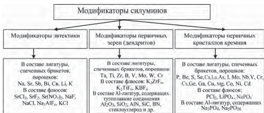
Рис. 2. Классификация применяемых модификаторов алюминиевых сплавов в зависимости от характера их воздействия на структуру
