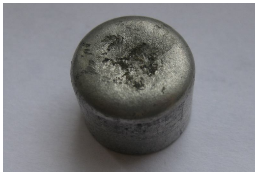
Рисунок 2 – Полученный слиток из сплава Co-Cr-Mo
