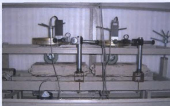
Рисунок 5 – Общий вид установки нагружения колесом
