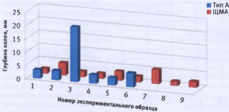
Рисунок 3 – Глубина колеи для экспериментальных образцов
