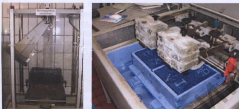
Рисунок 2 – Изготовление опытных образцов и проведение испытания на образование колеи (Wheel Tracking Test)
