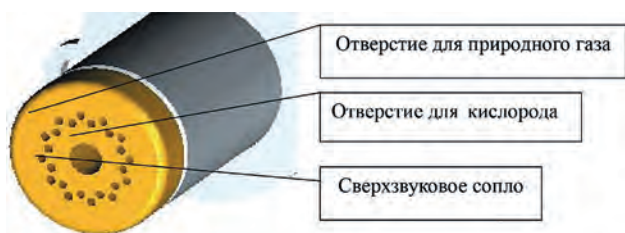
Рис. 1. Газокислородная когерентная горелка
