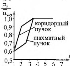
Рис. 5.36. Диаграмма изменения коэффициентов теплоотдачи по рядам коридорного и шахматного пучков труб: i — число рядов
