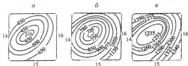
Рис. 4.2. Распределение температуры (изотермы) в среднем поперечном сечении опытном слитка: а – через 4 ч от начала нагрева; б – через 7 ч; в – через 12 ч 1
