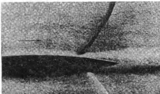
Рис. 3.19. Взаимодействие скачков уплотнения и пограничного слоя. Случай 5: пограничный слой турбулентен; позади скачка происходит отрыв ( Ma = 0,90 ; Re = 1,75 \cdot 10^6 ) (по Липману)
