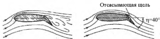
Рис. 3.25. Течение на крыле самолета с отсасыванием пограничного слоя через щель между задней кромкой крыла и закрылком: а — без отсасывания, течение полностью оторвалось от закрылка; б — с отсасыванием, течение потока прилегает к закрылку
