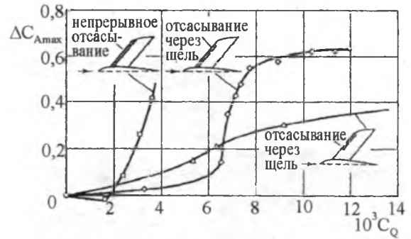
Рис. 3.24. Повышение максимальной подъемной силы стреловидного крыла посредством отсасывания пограничного слоя. Сравнение результатов при пористом (непрерывном) отсасывании и отсасывании через щель (измерения Э.Д. Полптона.) Re = 1,3 \cdot 10^{-6} , относительная ширина щели \frac{s}{l} = 0,004
