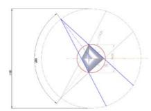
пожарных извещателей различных вариантах конструкций.  $\mathbf{C}$ целью, с помошью этой SolidWorks, была разработана модель макета оптической камеры определенного объема, и изучалось влияние взаимного расположения источника и приемника излучения и конструктивных особенностей камеры на величину полезного объема извещателя.
