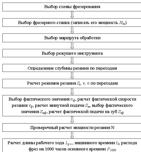
Рисунок 1 – Обобщенный алгоритм расчета режимов резания на фрезерных станках
