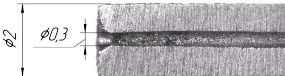
Рисунок 1 – Поперечный разрез капилляра, полученного из молибденового порошка по технологии СИП
