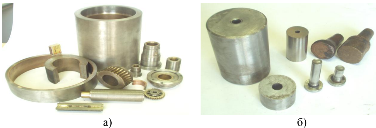
Рисунок 1 – Детали с функциональными покрытиями, полученные а – индукционной и б – электроконтактной наплавкой
