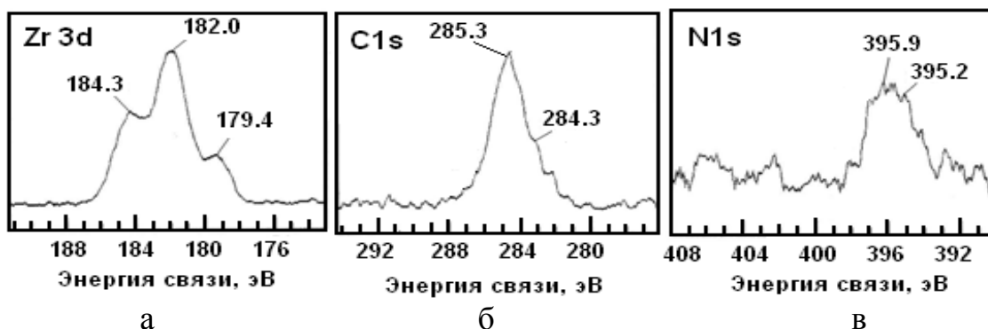
Рисунок 1 – РФЭС спектры основных элементов Zr–C–N пленки: Zr (а), С (б) и N (в) с указанием энергии (эВ) отдельных пиков
