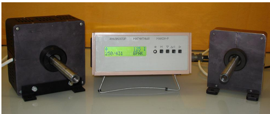
Рисунок 1 – Прибор «МАКСИ–Р» с контролируемыми изделиями типа «Ось коромысел» в ЦЗЛ филиала ОАО «Минский моторный завод» в г. Столбцы
