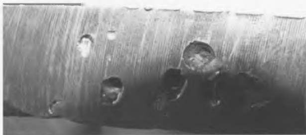
Рисунок 1 — Срез детали с раковинами
