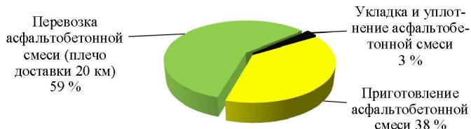
Рис. 4. Структура затрат на создание асфальтобетонного покрытия
