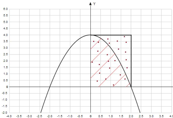
Рисунок 1. Вычисление определенного интеграла методом Монте-Карло через площадь.
