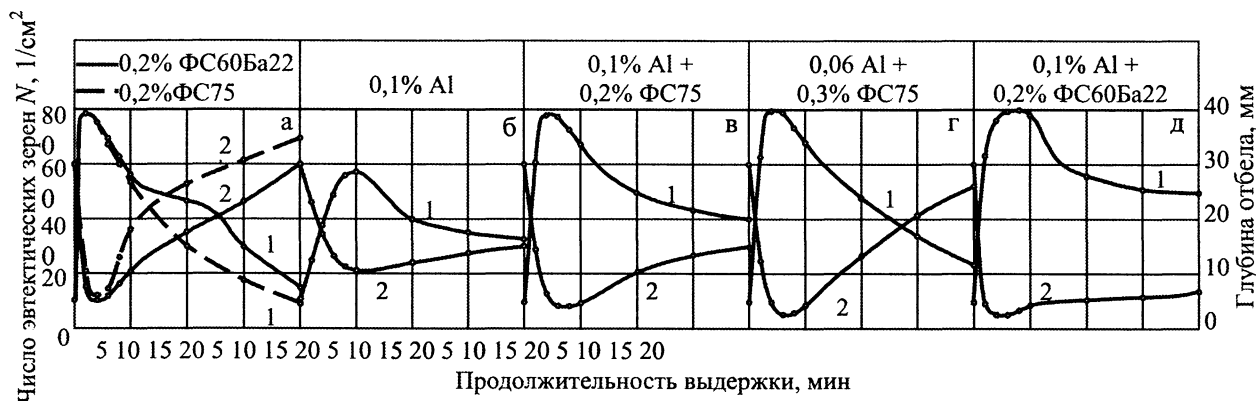
Рис. 2. Влияние продолжительности выдержки расплава при температуре 1400 °С на число эвтектических зерен (1) и глубину отбела (2) чугуна, модифицированного 0,2% ФС75, 0,2% ФС60Ба22 (а), 0,1%Al (б), 0,1%Al+0,2%ФС75 (в), 0,06%Al+0,3%ФС75 (г) и 0,1%Al+0,2%ФС60Ба22 (д)
