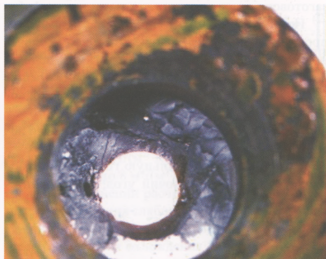
Рис. 2. Сплав UF10, волока-заготовка 20×17 мм (диаметр 4,35 мм), разрушена выходная распушка после 38 ч эксплуатации
