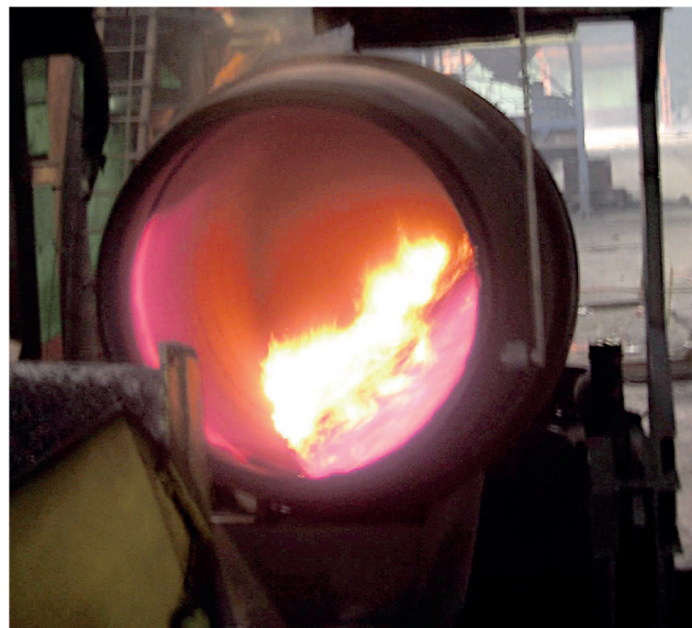
Рис. 2. Нагрев чугушной стружки в ротационной печи, ОАО «ГОМЕЛЬСКИЙ ЛИТЕЙНЫЙ ЗАВОД «ЦЕНТРОЛИТ»
