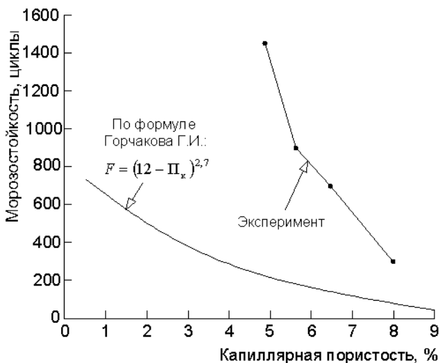
Рис. 4. Взаимосвязь капиллярной пористости цементного камня и количества циклов замораживания / оттаивания
