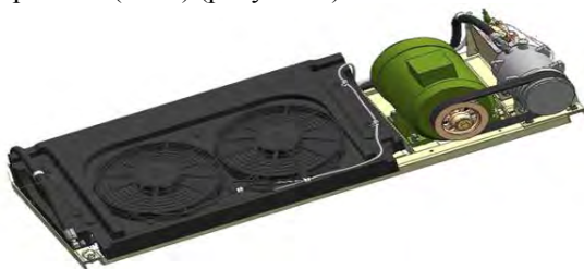
Рисунок 1 - Пример полной трехмерной твердотельной модели компрессорно-конденсаторного агрегата
